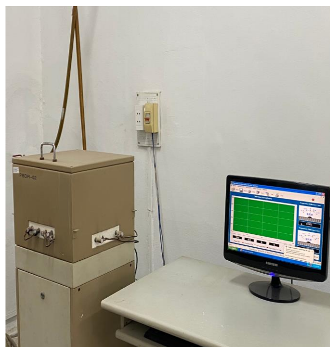
Thiết bị thử nhiệt độ biến dạng dưới tải trọng vật liệu chịu lửa
