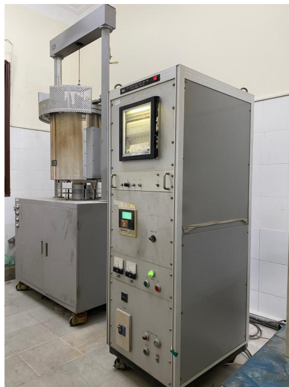
Thiết bị thử nhiệt độ biến dạng dưới tải trọng vật liệu chịu lửa
