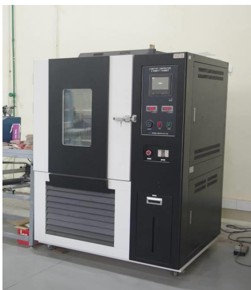
Tủ khí hậu thí nghiệm độ kín kính hộp
